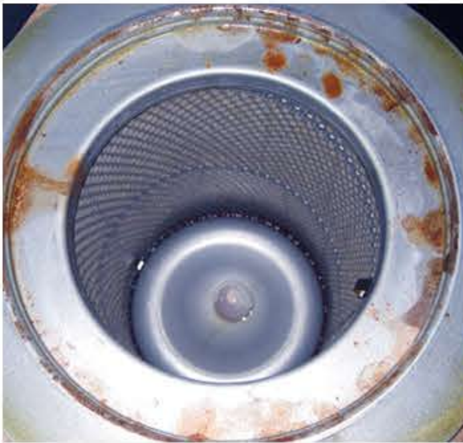
하우스 브랜드 윤활유로 6,000시간 가동 후 육안검사 시 Deposit이 외부에 쌓임
